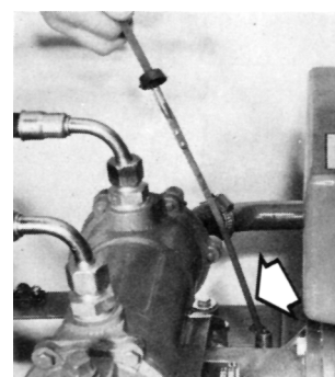
Contrôle du niveau d'huile dans inverseur Twin Disc
