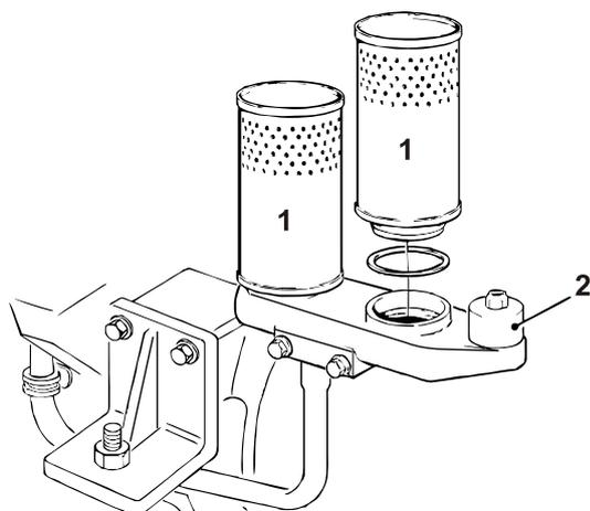
Si de l'air mélangé à de l'huile commence à sortir du clapet de surpression (2) les filtres (1) devront être remplacés plus tôt.
