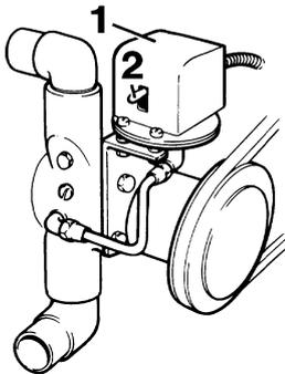
La pompe de cale et de rinçage est accouplée/désaccouplée via un interrupteur qui habituellement est monté près du poste de commande principal. La pompe de cale peut aussi être accouplée manuellement en appuyant sur le levier (2) pendant environ 20 secondes.
