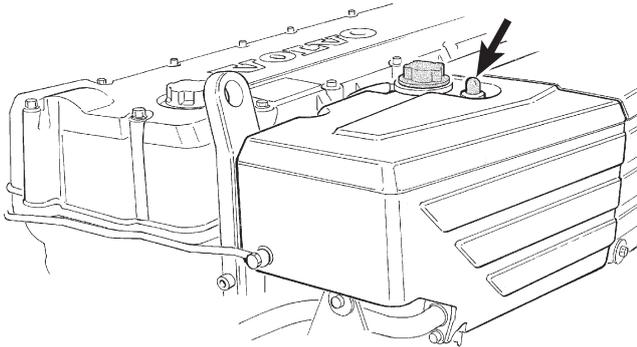
**L'élément flottant de couleur verte doit être visible sur le voyant.**
