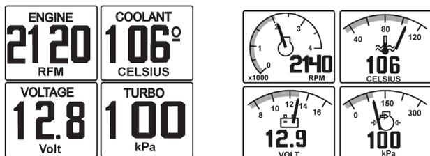
Exemple d'affichage dans plusieurs fenêtres pour une installation à un seul moteur
