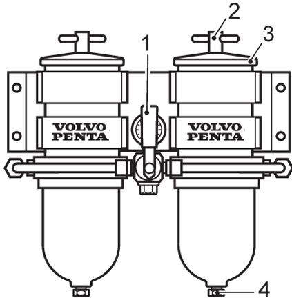
1. Placer un récipient approprié sous les filtres et fermer le filtre à remplacer.
