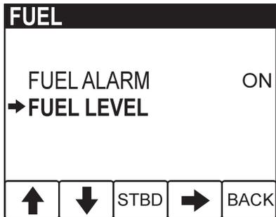
La touche supplémentaire 3 s'affiche si l'affichage est configuré pour un moteur bâbord, tribord ou double. Le titre FUEL est modifié pour afficher le moteur sélectionné pour la marche ou l'arrêt de la fonction d'alarme ON/OFF.
