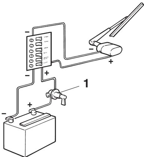
3. La masse de protection pour par ex. les équipements de radio ou de navigation, le gouvernail, les échelles ou tout autre équipement comportant des câbles séparés de mise à la masse de protection, devront être regroupés en un raccord de masse commun, séparé du groupe de propulsion ou d'inversion.
