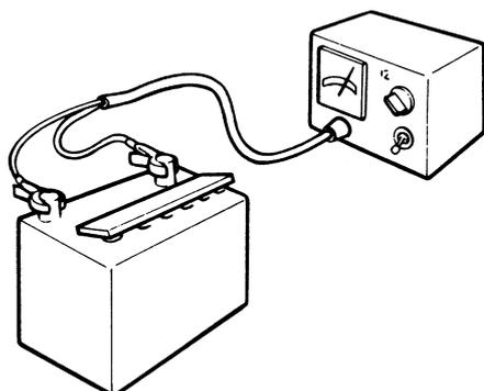
**⚠ AVERTISSEMENT !** Danger d'explosion ! Les batteries émettent du gaz d'hydrogène pendant la charge; celui-ci, mélangé à l'air, peut former un gaz explosif, le gaz oxyhydrique. Un court-circuit, une flamme nue ou une étincelle peuvent provoquer une grosse explosion. Assurez-vous que la ventilation est bonne.
