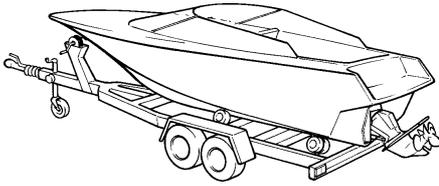
**⚠ IMPORTANT !** Il ne faut jamais faire tourner le moteur lorsque la transmission se trouve en plage de montée. Avant de remorquer le bateau, il faut toujours bloquer la transmission en position montée, à l'aide d'un Kit de remorquage (accessoire) ou similaire, afin de l'empêcher de tomber.
