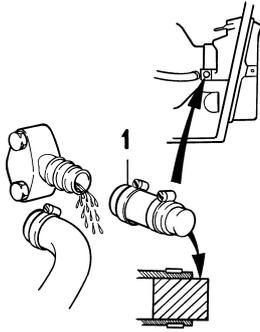
**⚠ AVERTISSEMENT !** Si le bateau est laissé dans l'eau, l'admission d'eau de mer vers le moteur doit être coupée à l'aide d'une vanne d'eau de mer (équipement non-standard) ou par une autre méthode, avant de procéder à la vidange du moteur. Si l'eau n'est pas vidangée correctement, le bateau peut se remplir d'eau et couler. Pompez l'eau du bateau et veillez à ce qu'il n'y ait aucune fuite avant de quitter le bateau.
