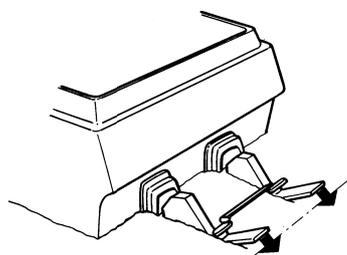
Lors du relevage en parallèle, il faut d'abord équilibrer la transmission sur sa position de butée avant (0). Commencez l'opération de relevage dans cette position.
