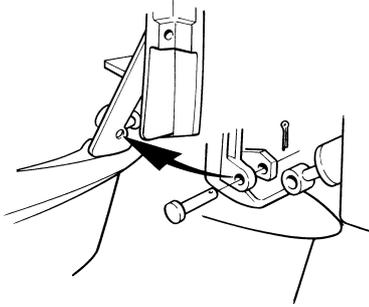
**⚠ AVERTISSEMENT !** Ne travaillez jamais sur les soufflets de la transmission ou sur le système hydraulique sans bloquer la transmission en position remontée, de manière à l'empêcher de tomber. La chute de la transmission peut entraîner de graves blessures corporelles.
