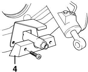
**⚠ AVERTISSEMENT !** Risque de pénétration d'eau. Veillez attentivement à ce que la plaque de support bloque en place le capteur d'assiette avant d'installer l'anode en zinc et de serrer les vis.
