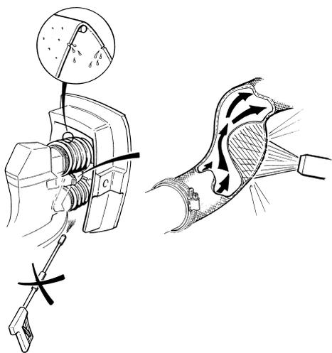
**⚠ IMPORTANT !** Procédez avec précaution lors du nettoyage à l'aide d'un jet d'eau haute pression. Ne dirigez jamais le jet sur les joints, les soufflets d'échappement et de la transmission, les joints du cylindre d'assiette, le joint de l'arbre d'hélice, les flexibles, etc.
