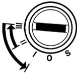
4. Tournez la clé jusqu'à la position « III » pour démarrer. Relâchez la clé dès le démarrage du moteur, la clé revient automatiquement en position « I ». Si le moteur n'a pas démarré, vous devez tourner la clé en position « 0 » avant de procéder à un nouvel essai.
