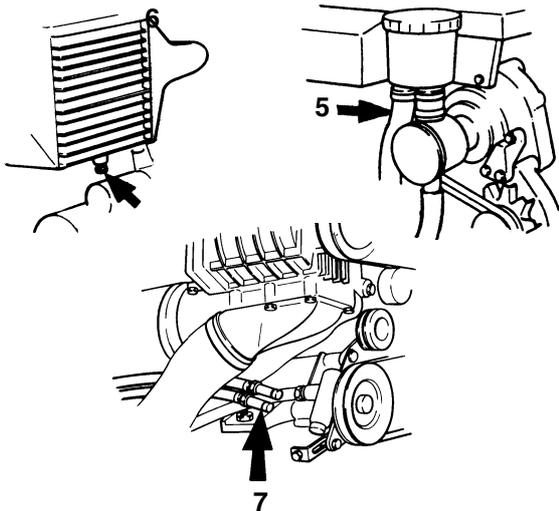
2. Débranchez le flexible (5) et vidangez l'eau de l'échangeur thermique. Vidangez le refroidisseur d'air de suralimentation en ouvrant le bouchon (6), et le refroidisseur d'huile en ouvrant le bouchon sur le flexible repéré en bleu (7).
