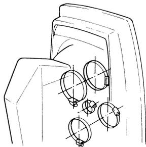
**DP, DPX** : Les vis de serrage des flexibles doivent être positionnées conformément à l'illustration une fois serrées.
