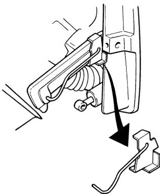
Il est à présent possible de soulever la transmission à la main jusqu'à sa position remontée. Maintenez la transmission dans cette position et installez l'outil sur le côté tribord, conformément à l'illustration. Contrôlez avec soin l'état des soufflets. Il est possible de remplacer les soufflets d'échappement sans démonter la transmission.
