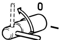
**⚠ IMPORTANT !** Ne coupez jamais le circuit à l'aide des interrupteurs principaux lorsque le moteur tourne. Ceci pourrait gravement endommager l'alternateur.
