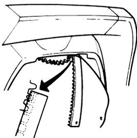
**DP** : Si la transmission a été démontée, la crémaillère de position et la roue dentée commandant le capteur d'assiette seront peut-être déplacées. Tournez la roue dentée jusqu'à ce que la dent entaillée soit visible. Installez la crémaillère de manière à ce que la première position de la roue dentée corresponde à la dent entaillée.
