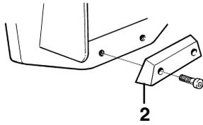
Dévissez les deux vis de fixation de l'anode (2). Retirez l'anode et la plaque de support sous l'anode. Nettoyez la surface de contact. Reposez la plaque de support et l'anode neuve.
