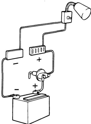
5. Si une batterie auxiliaire est utilisée, un interrupteur principal doit être raccordé entre sa borne + et le bloc fusibles, et la borne (+) et le bornier de l'équipement électrique du bateau. L'interrupteur principal de la batterie auxiliaire doit couper tous matériels consommateurs d'électricité reliés à cette batterie et doit être coupé lorsque la puissance électrique n'est plus nécessaire.
