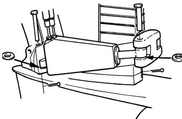
**DPX :** Démontez également les cylindres de direction en retirant les goupilles. Attachez les cylindres de direction, pour qu'ils ne gênent pas l'intervention.
