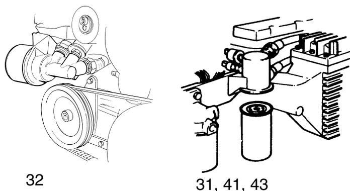
Dévissez l'ancien filtre. (Pour éviter les gaspillages d'huile, placez un sachet en plastique en dessous du filtre avant de le dévisser). Vérifiez que la surface de contact du moteur est propre. Lubrifiez le joint en caoutchouc du filtre avec un peu d'huile. Vissez le nouveau filtre à la main, jusqu'à ce qu'il entre en contact avec la surface de contact. Faites ensuite un demi-tour supplémentaire, **mais pas plus !**
