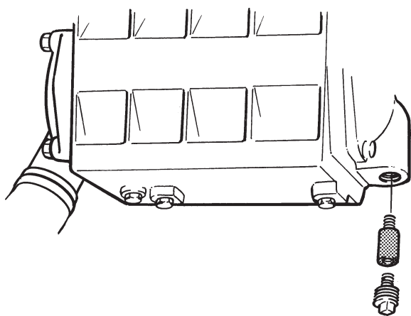
TAMD63: Anode en zinc dans le flasque avant l'échangeur thermique
