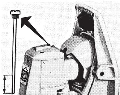
Ce contrôle se fait avec la transmission en position complètement rabattue. L'huile doit se trouver entre les deux repères de la jauge qu'il convient de ne pas visser en place lors du contrôle. Veiller à ne pas laisser pénétrer l'eau dans la transmission lors du contrôle. Si nécessaire, faire l'appoint d'huile jusqu'au trou de montage de la jauge. Concernant le choix d'huile, prière de se référer aux « Caractéristiques Techniques ».
