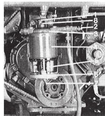
Nettoyer soigneusement tout le boîtier de filtre extérieurement. Démonter la vis centrale sur le couvercle et déposer la cuve et le filtre. Nettoyer soigneusement la cuve intérieurement. Vérifier que les joints sont bien entiers. Monter un nouveau filtre. Purger le système d'alimentation (voir à la page 24).
