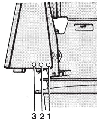
La goupille de réglage de la platine détermine la position de l'angle d'assiette de la transmission. Cette goupille peut se placer dans les trois trous suivant :
