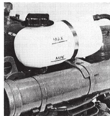
Contrôler avant le premier démarrage de la journée le niveau de liquide de refroidissement qui doit se trouver entre les repères MAX et MIN. Faire l'appoint en cas de nécessité avec de l'eau douce ou avec un mélange antigel anticorrosif.
