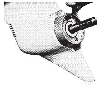
Remplacer l'anneau de zinc derrière l'hélice lorsqu'il est corrodé à moitié. Prière de se référer au titre « Dépose et pose de l'hélice ».
