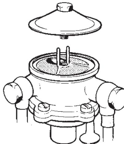
La pompe à carburant du moteur est équipée d'une crépine incorporée, accessible après la dépose du couvercle. Cette crépine doit être nettoyée au moins une fois par saison.
