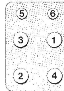
Resserrez les écrous en vous servant d'une clé dynamométrique avant la première mise en marche d'un moteur neuf ou nouvellement remis à neuf. Refaire l'opération après 20 heures de service.
