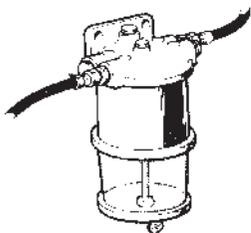
Si le moteur est équipé d'un filtre supplémentaire à carburant, avec séparateur d'eau, vérifiez de temps à autre par la cuve transparente s'il n'y a pas de mélange éventuel d'eau avec du carburant. Si nécessaire, videz l'eau par le robinet de vidange au fond de la cuve du filtre. Faites attention aux éclaboussures de carburant. Pompez pour faire remonter le carburant et purgez le système d'alimentation. La cartouche de ce filtre doit également être remplacée au moins une fois par saison.
