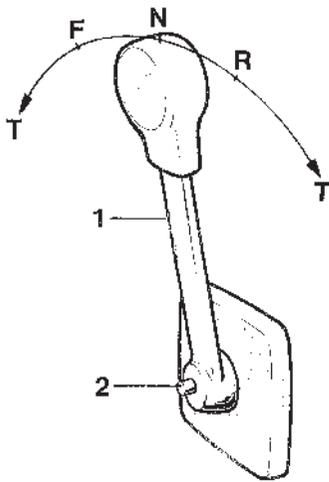
Système de commande monolevier Volvo Penta
