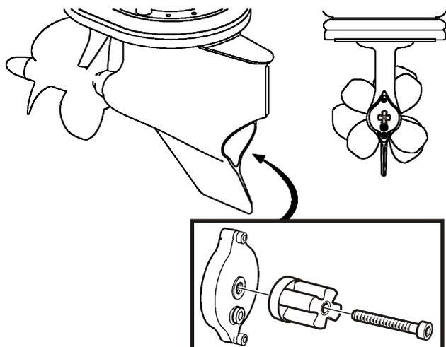
Vérifier régulièrement les anodes sacrificielles. Deux anodes par embase, une fixée sur l'embase et l'autre sur le tableau arrière. Voir les illustrations. Remplacer une anode lorsque environ 1/3 de l'anode a été mangé par l'oxydation.
