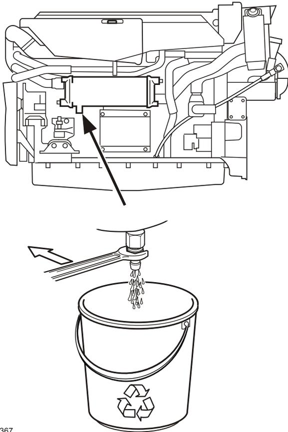
Rincer le système de refroidissement lors de la vidange du liquide de refroidissement, afin d'éliminer toute trace de dépôts.
