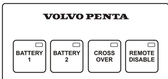
**BATTERY 1**, interrupteur pour activer/désactiver la batterie de démarrage.
