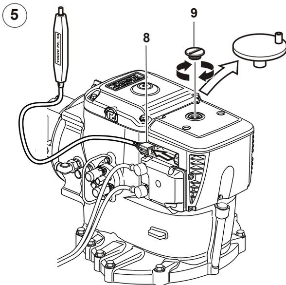
5 Déposer l'outil manivelle. Détacher le rupteur (8) en abaissant l'étrier et tirant sur le rupteur dans un mouvement basculant. Remonter le bouchon (9).
