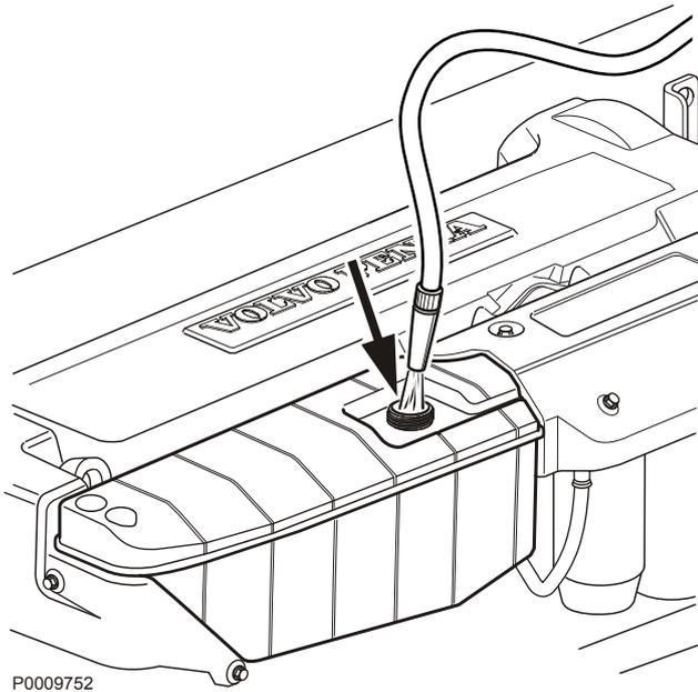
Rincer le système de refroidissement lors de la vidange du liquide de refroidissement, afin d'éliminer toute trace de dépôts.
