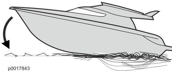
A Régler l'angle d'attaque (l'angle entre la proue et la surface de l'eau). Améliore la visibilité du barreur pour assurer un passage sûr.
