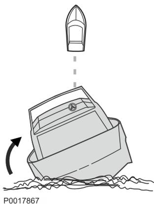
B Réglage de l'angle de roulis lors du déplacement droit devant. Compense la gîte du bateau afin d'améliorer le confort par exemple lorsque le bateau est inégalement chargé ou dans un vent de côté.
