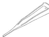
**NOTE !** Utiliser uniquement l'outil Volvo Penta fourni avec le SDU pour la réinitialisation.
